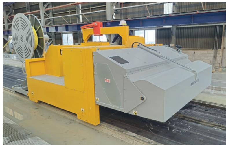
Machine multifonction pour le nettoyage des bancs
