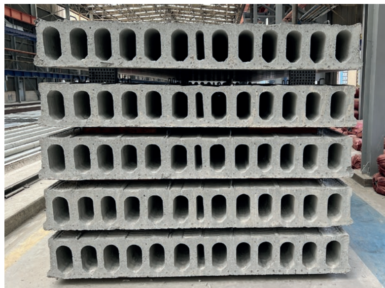
Prédalles et dalles alvéolées fabriquées avec la machine à coffrage glissant d'un fabricant local
