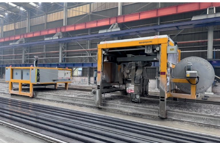
Scie automatique multi-angles avec chariot à contrepoids
