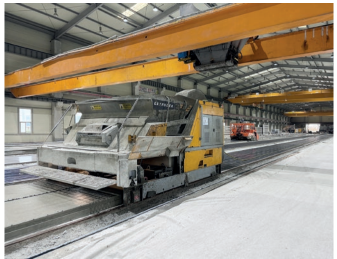
L'extrudeuse EVO2 pour doubles planchers de 2,4 m pendant le coulage du béton
