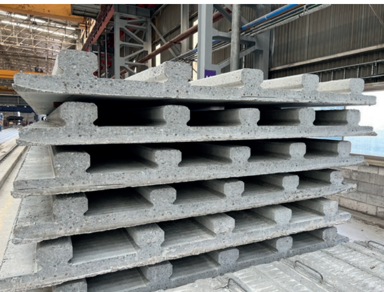
Prédalles et dalles alvéolées fabriquées avec la machine à coffrage glissant d'un fabricant local
