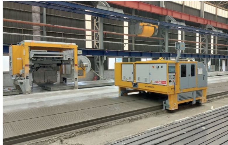
Le traceur et la scie multi-angles fonctionnent de façon entièrement automatique.
